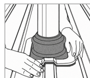
4. Adapte Dektite® a la forma de la chapa perfilada.
